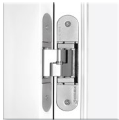
Tectus Band TE 340 3D Verdeckt liegendes 3D Tectus Band mit einem Öffnungswinkel von 180° (Verstellbereich seitlich +/- 3 mm, Höhe +/- 3 mm, Andruck +/- 1 mm)
